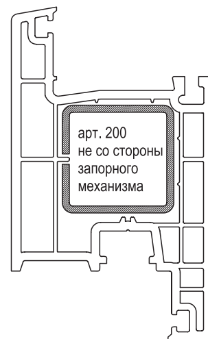
арт. PR 2.096 Вариант установки армирования в створке не со стороны запорного механизма
